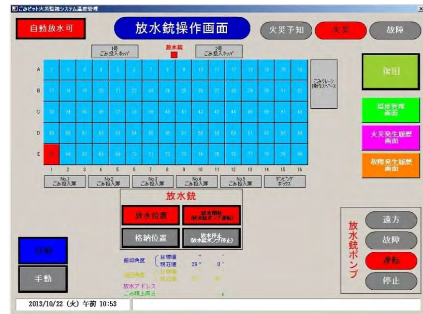
自動モード火災発生時
