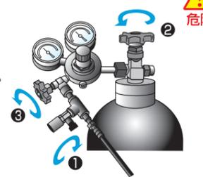
圧力調整器の二次圧力は、1.3MPa~1.5MPaにしておいてください。
