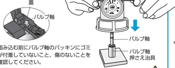
組み込む前にバルブ軸のバックシンにゴミが付着していないこと、傷のないことを確認してください。
