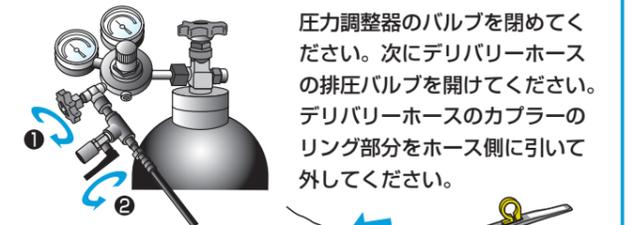
圧力調整器のバルブを閉めてください。次にデリバリーホースの排圧バルブを開けてください。デリバリーホースのカブラーのリング部分をホース側に引いて外してください。
