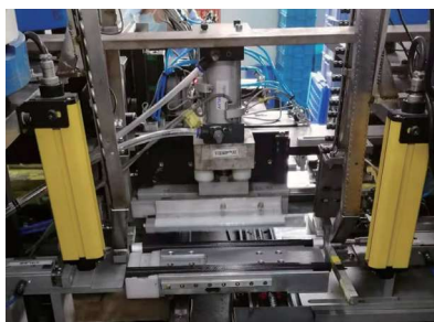
喷管自动组立 | ホース自動組立 Automatic Hose Assembly
